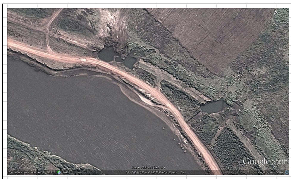
Figura 3.13: Crateras no dique de defesa a montante da cidade de Xai Xai.
