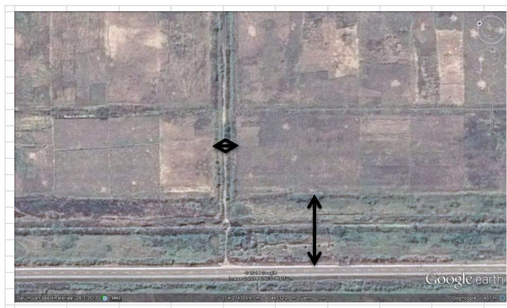
Figur 5.7: Camaras de empréstimo não centralizadas ao longo dos canais de irrigação
